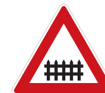
A 29 Železniční přejezd se závorami
