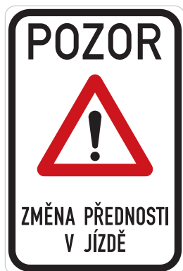
IP 22 Změna místní úpravy
