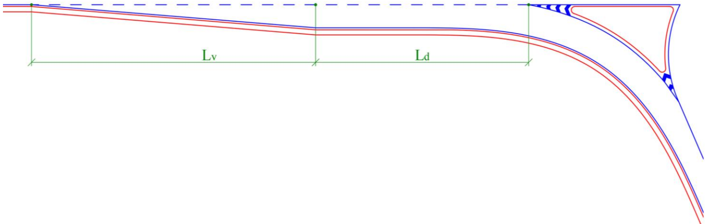
obr. 1100 (kóty a tvar odbočovacího pruhu vpravo na hlavní komunikaci)
