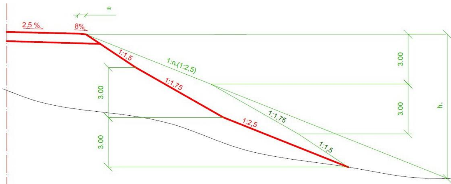
obr. 0550 (postup konstrukce násypových svahů s víceúrovňovým uspořádáním)
